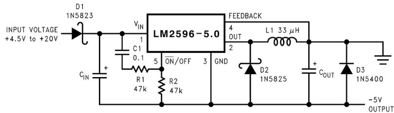
$C_{IN}$  —68  $\mu\text{F}/25\text{V}$  Tant. Sprague 595D
